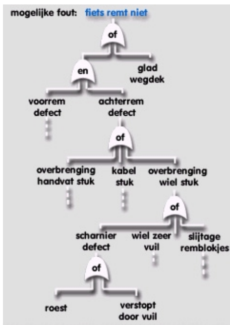
Ill. 7: Een stuk foutenboomanalyse voor een fiets.
